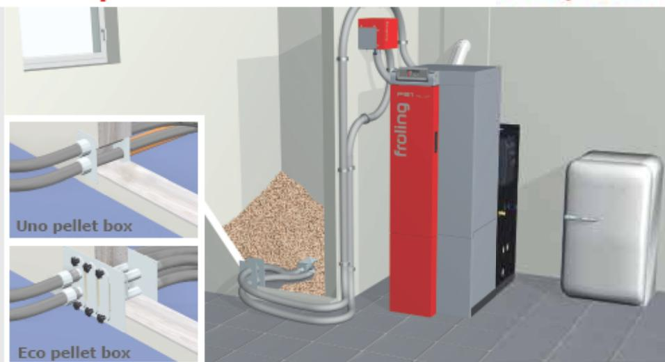
Универсальная пневмосистема позволяет транспортировать пеллеты даже на большое расстояние от топливного бункера до котельной. Расположение узлов всасывания или передаточного модуля (Pellets-Box) можно индивидуально адаптировать к топливному бункеру. Переключение между пневмоузлами ручное (**Eco pellet box**). Есть также версия для небольших квадратных помещений с одним пневмоузлом (**Uno pellet box**).
