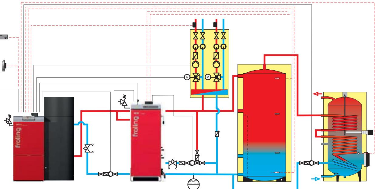
P4 Pellet с S3 Turbo, тепловым аккумулятором и Unicell NT-S
