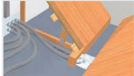
Вес пеллет должен распределяться на несущую конструкцию, а не на разгрузочный канал. Необходимо оборудовать наклонный пол под углом 30–45° с гладкой поверхностью, чтобы обеспечить оптимальное ссыпание пеллет. В зависимости от статической нагрузки может потребоваться установка промежуточных подкосов.
