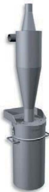
Это устройство гарантирует чистоту и высокое качество пеллет. Возможные остатки древесной пыли отделяются от топлива с помощью пылеуловителя PST. Это обеспечивает эффективную работу камеры сгорания. Пылеуловитель PST устанавливается в произвольном месте на линии обратного воздуха системы пневмоподачи топлива.
